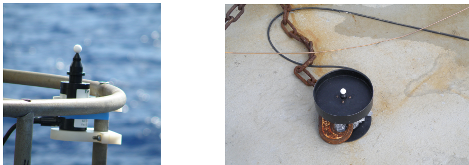
Figure 6 : A gauche, le capteur PAR installée sur la structure de la rosette permettant la mesure de l'irradiance dans la colonne d'eau (0-1000m) ; à droite, capteur PAR installée sur le pont du bateau mesurant l'irradiance incidente.
